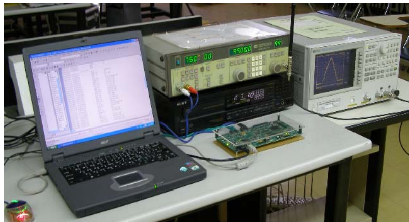
รูปที่ 4.19 ลักษณะการต่ออุปกรณ์เพื่อวัดสเปกตรัมบีบอัด สัญญาณพัลส์พลวัตแบบหลายแบนด์
