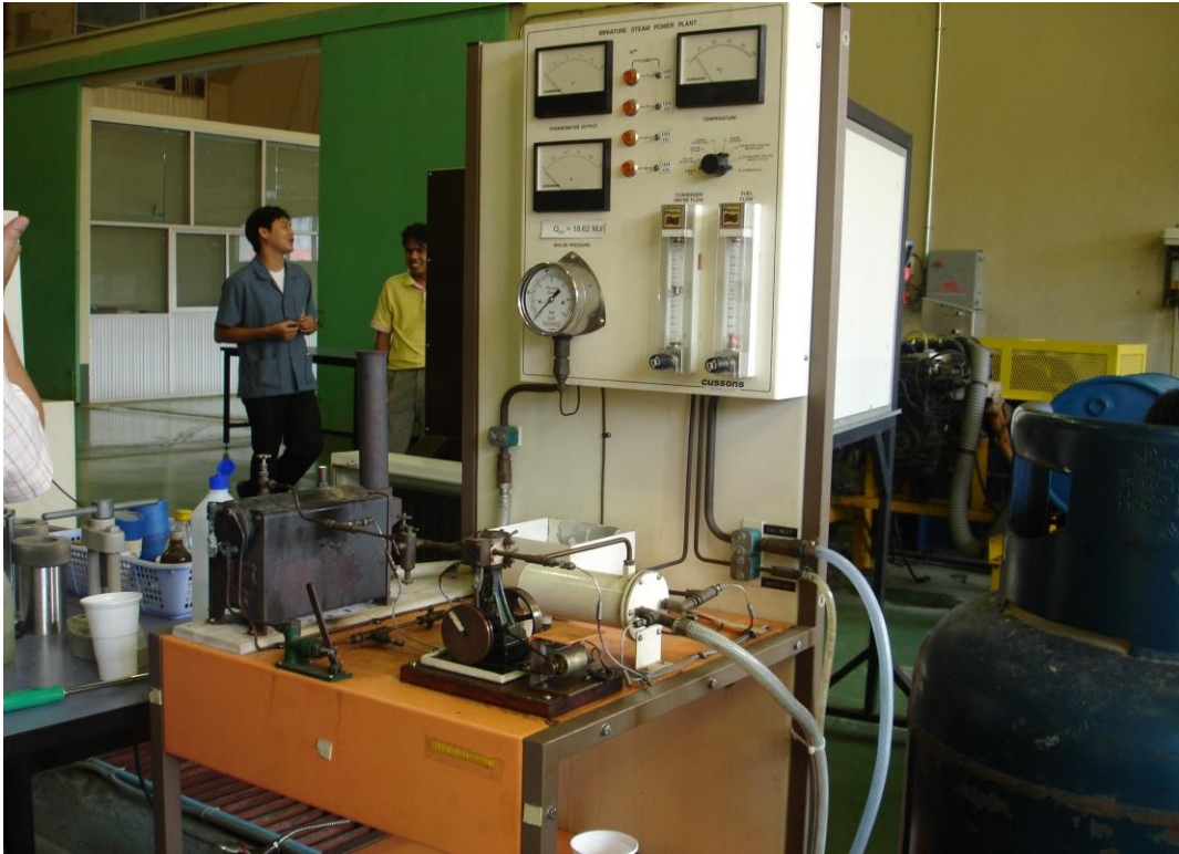
รูปที่ 17 Miniature Steam Power Plant (Miniature Stream Power Plant)
