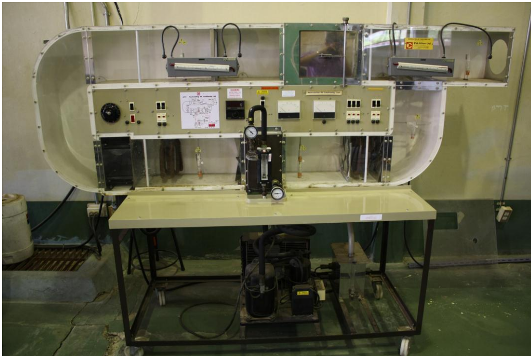
รูปที่ 26 Air Conditioning Test ( Air Conditioning System )
