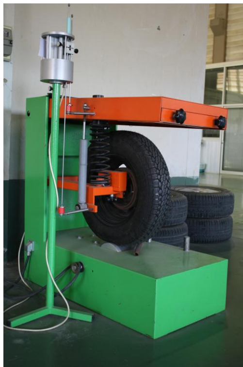
รูปที่ 36 Suspension Test ( Suspension System )
