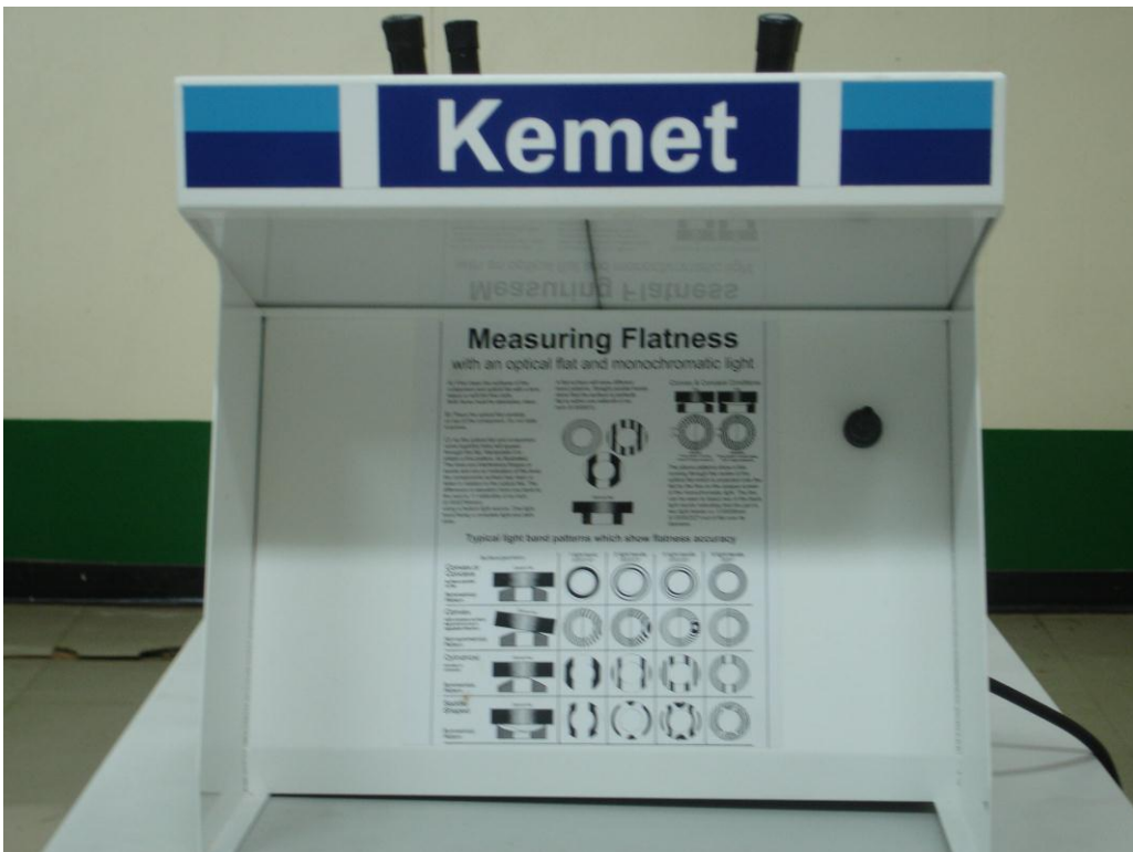
รูปที่ 56 Measuring Flatness ( Measuring Tool )
