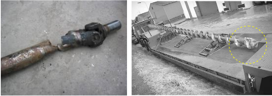
รูปที่ 1 ความเสียหายจากผลของแรงบิด (ซ้าย) เพลารถยนต์ (ขวา) เพลาเจาะ
