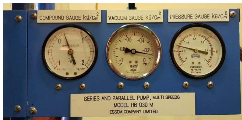
รูปที่ 7 เกจวัดความดันแบบต่าง ๆ ในการชุดการทดลอง
