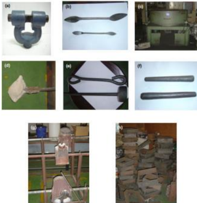
รูปที่ 5 อุปกรณ์สำหรับเตรียมแบบทราย ประกอบไปด้วย a) กระสวน b) ซ่อนใบไม้ c) เครื่องผสมทราย d) กระบวยตักน้ำโลหะ e) ค้อน Rammer f) Sprue g) ไม้เท และ h) หีบแบบ
