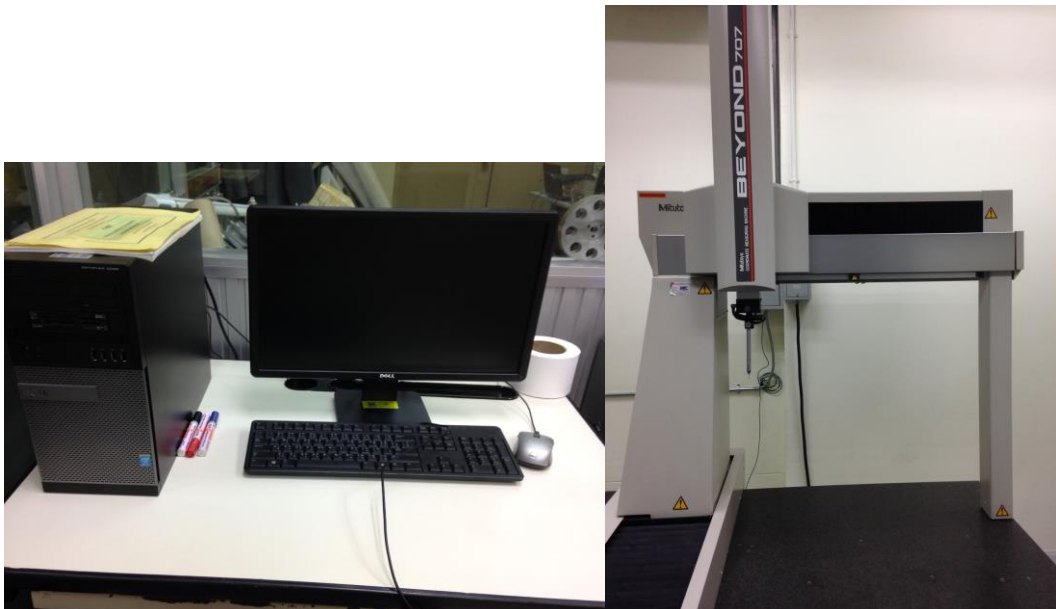
รูปที่ 2 ฐานของเครื่อง CMM mitutoyo cmm 707
