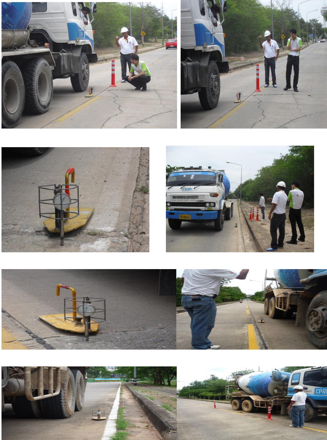
รูปที่ 4.24 การทดสอบค่ายุบตัวของแผ่นพื้นคอนกรีต
