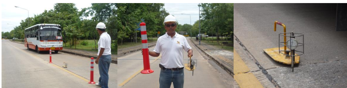
รูปที่ 3.4 การวัดค่าการทรุดตัวของแผ่นพื้นถนนคอนกรีตเสริมเหล็ก
