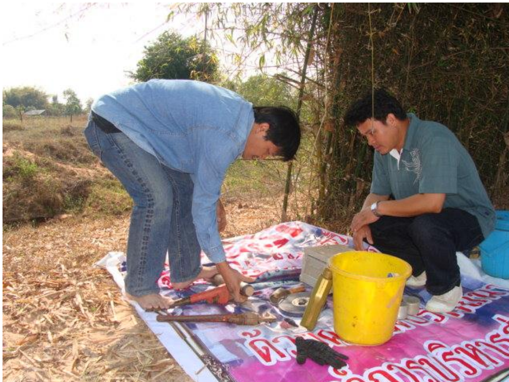
รูปที่ 4.4 การทดสอบทะลุทะลวงมาตรฐาน(Standard Penetration Test, SPT)
