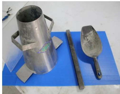
รูปที่ 3.7 ชุดทดสอบค่ายุบตัวของคอนกรีต
