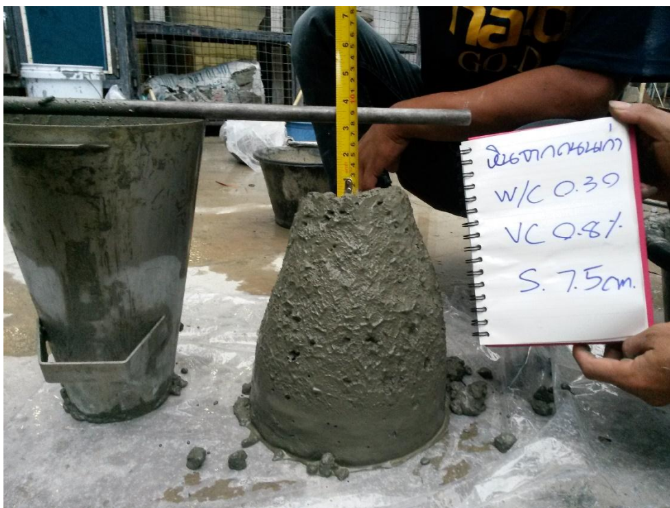
รูปที่ ค.7 ภาพการทดสอบความยุบตัวของคอนกรีตสดที่ใส่น้ำยาลดน้ำร้อยละ 0.8 ที่ W/C = 0.30
