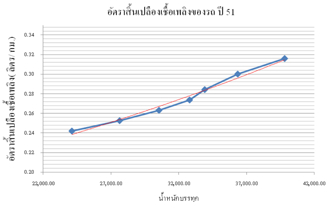
รูปที่ 4.6 ความสัมพันธ์ระหว่างน้ำหนักรบรรทุกกับอัตราการสิ้นเปลืองเชื้อเพลิงโดยวิธีสมการเอกซ์โพเนนเชียลของรถ ปี 51
