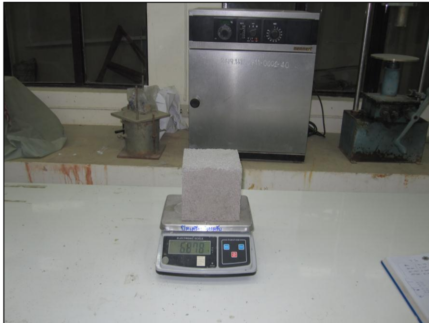
รูปที่ ค.14 การชั่งน้ำหนักตัวอย่างคอนกรีต 60:40 W/B 0.75
