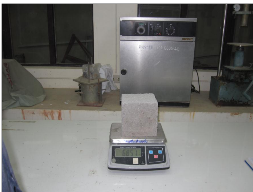
รูปที่ ค.13 การชั่งน้ำหนักตัวอย่างคอนกรีต 80:20 W/B 0.75
