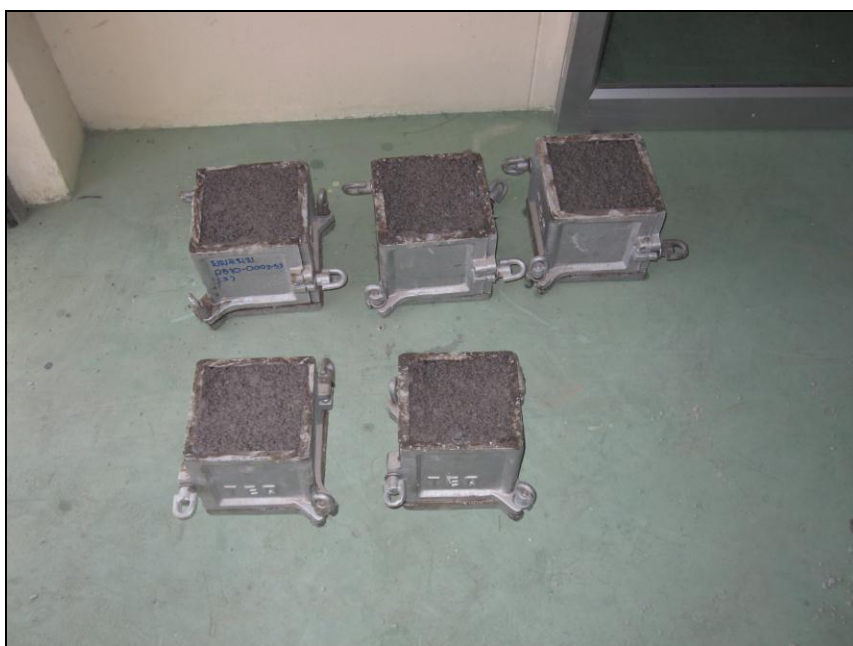
รูปที่ 4.1 การเตรียมส่วนผสมในแบบหล่อ
