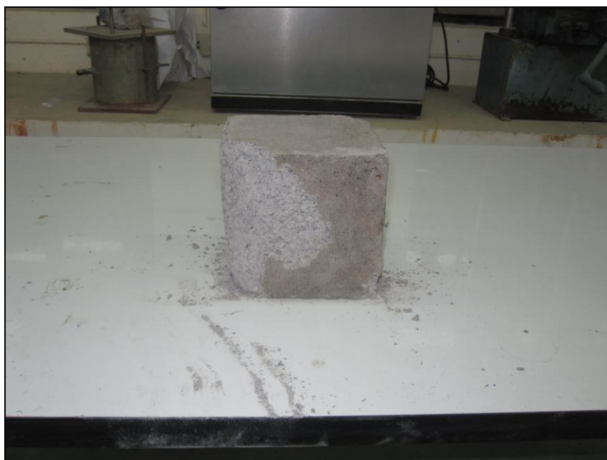
รูปที่ ค.24 การวิบัติของแท่งตัวอย่าง 40:60 W/B 0.75
