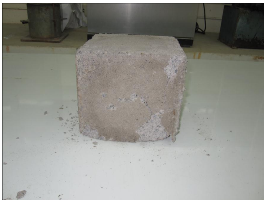
รูปที่ ค.22 การวิบัติของแท่งตัวอย่าง 80:20 W/B 0.75
